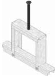
Cierre con tornillo anti-vandálico
