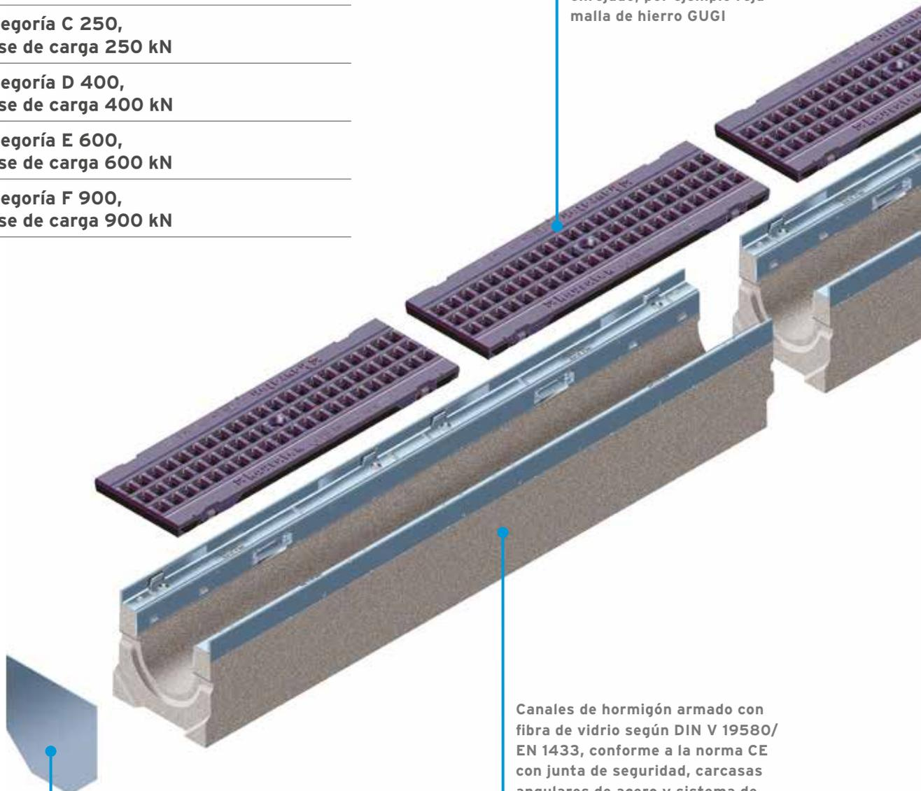
Canales de hormigón armado con fibra de vidrio según DIN V 19580/EN 1433, conforme a la norma CE con junta de seguridad, carcassas angulares de acero y sistema de cierre sin tornillos SIDE-LOCK con conexión de ranura y lengüeta para un montaje exacto.
